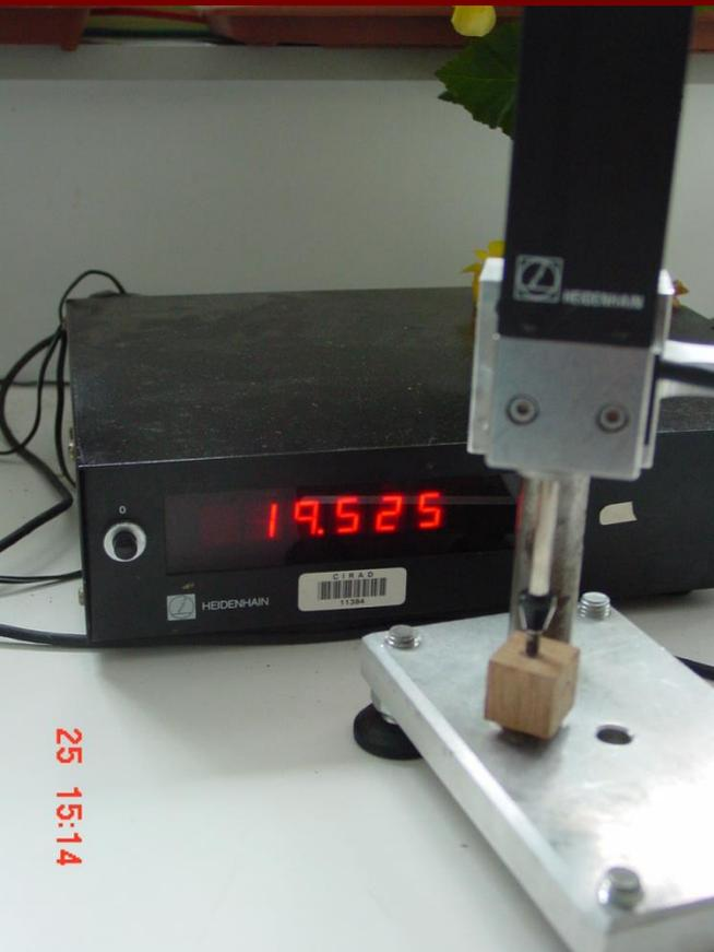
Un opérateur réalise une série de mesures d'épaisseur de matériaux à l'aide d'un capteur de déplacement monté sur un statif (mesures indépendantes).
